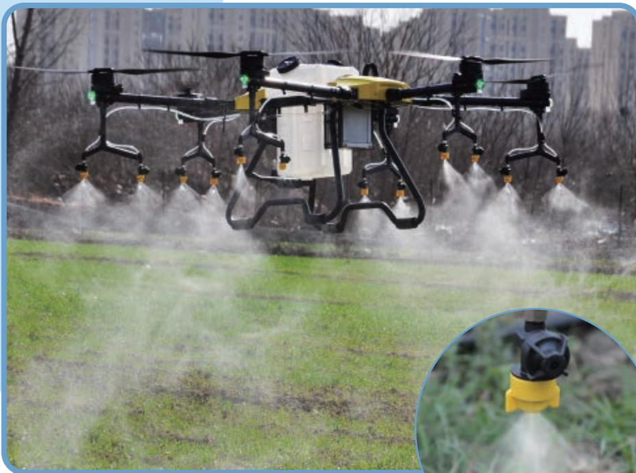
Boquillas de alta presión y boquillas centrífugas disponibles.
