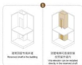
混凝土井道 Concrete shaft
